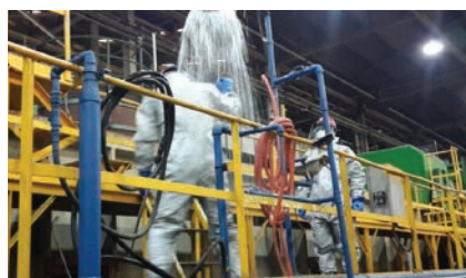
使用緊急沖淋設備
